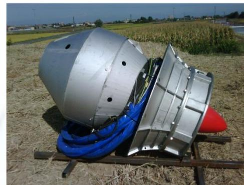
Primi in Italia con una turbina con efficienza > 80% su salti da 1,5 a 6 metri.
